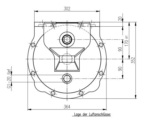
Bremszylinder BZ 12 SK-01 - 001 Luftanschluß unten - Verschlußschraube oben
